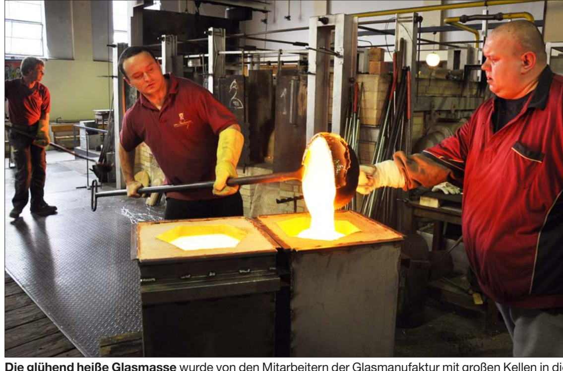
Die glühend heiße Glasmasse wurde von den Mitarbeitern der Glasmanufaktur mit großen Kellen in die Gussformen aus Sand geschöpft. – Foto: Hackl
