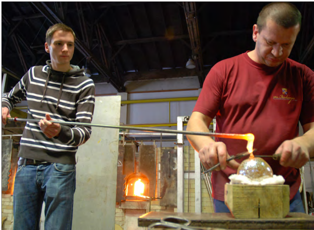
Kurz vor der Vollendung: Glasmacher Marcus Hackl (rechts) befestigt den Aufhänger an der Christbaumkugel. Unterstützt wird er von PNP-Volontär Tobias Wolf, der ihm mit der Glasmacherpfeife die zähfließende Glasmasse reicht. Doch bevor es soweit ist,...
