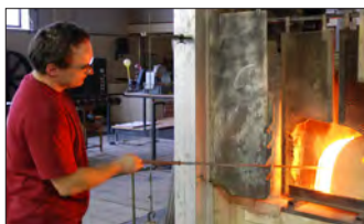
...holt der Glasmacher das bei rund 1400 Grad geschmolzene Glas aus dem Ofen,...
